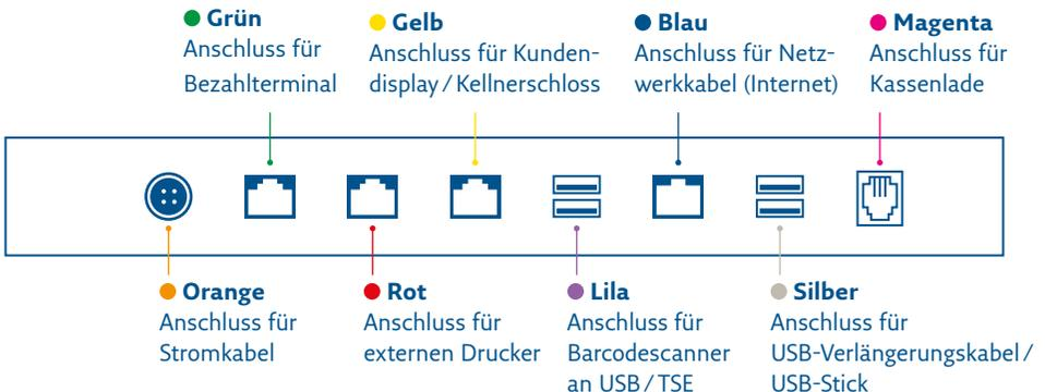
Die Schraubstecker werden an ein Adapterkabel angeschlossen, welche dann wiederum an die Kasse angeschlossen werden. Auch das RJ45 Kabel vom Terminal wird über einen Schraubstecker-Adapter mit der Kasse verbunden. Falls Schraubstecker mit der Kasse verbunden werden, ziehen Sie diese bitte nur leicht fest.
