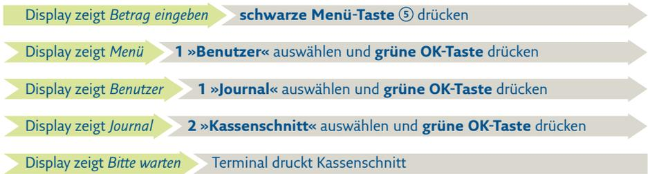
Sie erkennen die erfolgreiche Durchführung des Kassenschnittes an der Anzeige »Erfolgt« im Display und dem Aufdruck *Kassenschnitt Gebucht* auf dem Beleg.
